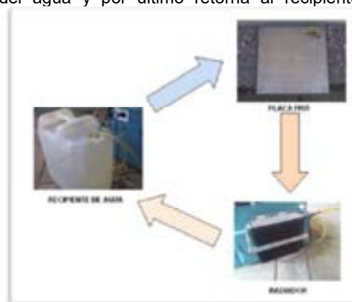
Figura 3. Circuito cerrado de enfriamiento
