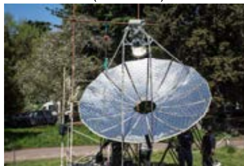
Figura 3. Prototipo de Concentrador Óptico con motor Stirling Area colectora 12 m 2 - 5 Kw.
