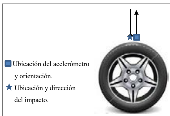
Figura 1. Configuración del ensayo según SAE J2710
