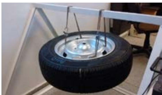
Figura 2. Estructura soporte del ítem de ensayo
